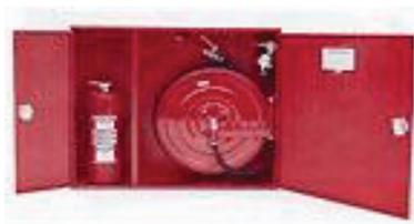
Die Einrichtungen der **erweiterten Löschhilfe** (Wandhydrant, nasse oder trockene Steigleitung) sind jährlich einer Funktionskontrolle und alle 5 Jahre einer Druckprüfung zu unterziehen. Entsprechende Prüfprotokolle müssen vorliegen.
